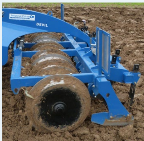
Travail complet en trois phases : Dents rigides - Cross-board et Éléments de consolidation.
