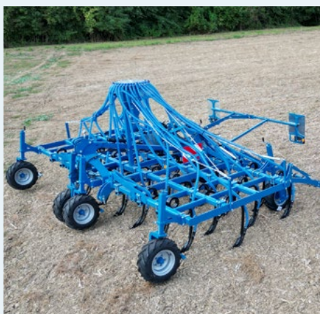
Dents réparties sur 4 rangées espacées de 160 mm.
