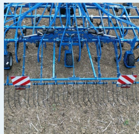
Peigne arrière pour nivellement et recouvrement homogène.
