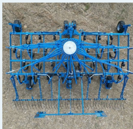
Châssis 3 points robuste avec roues 23/8.50x12.
