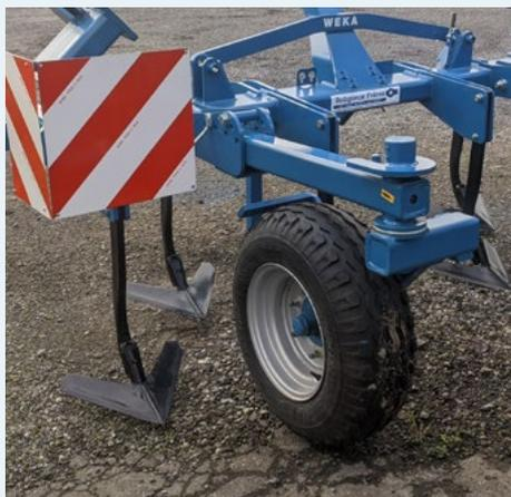
**Bon guidage favorisé par des roues de contrôle directionnelles et de grand diamètre.**
