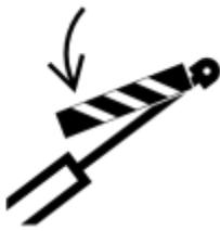
Ne jamais travailler sous l'outil pendant les travaux d'entretien et de maintenance, lorsque la machine ne repose pas sur des chandelles ou sur un support ferme. Bloquer mécaniquement l'accessoire en position haute.
