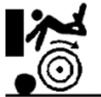
Ne monter jamais directement sur les roues, et ce, même à l'arrêt, car celles-ci risqueraient de se mettre à tourner.
