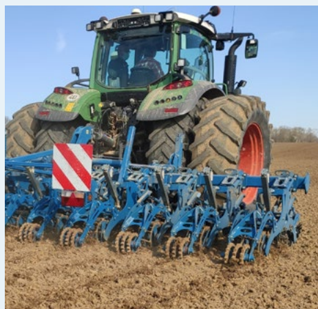
Réglage simple et rapide de l'inter-rang (de 45 à 80 cm)
